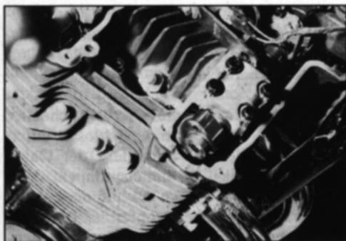
**Ventilspiel einstellen mit Spezial-Werkzeug, dann braucht keine Nockenwelle ausgebaut zu werden**
